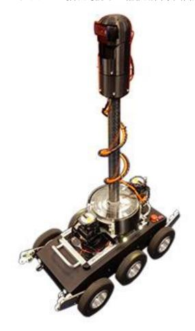
② パイプを探索する自走式小径管路点検口ボット
