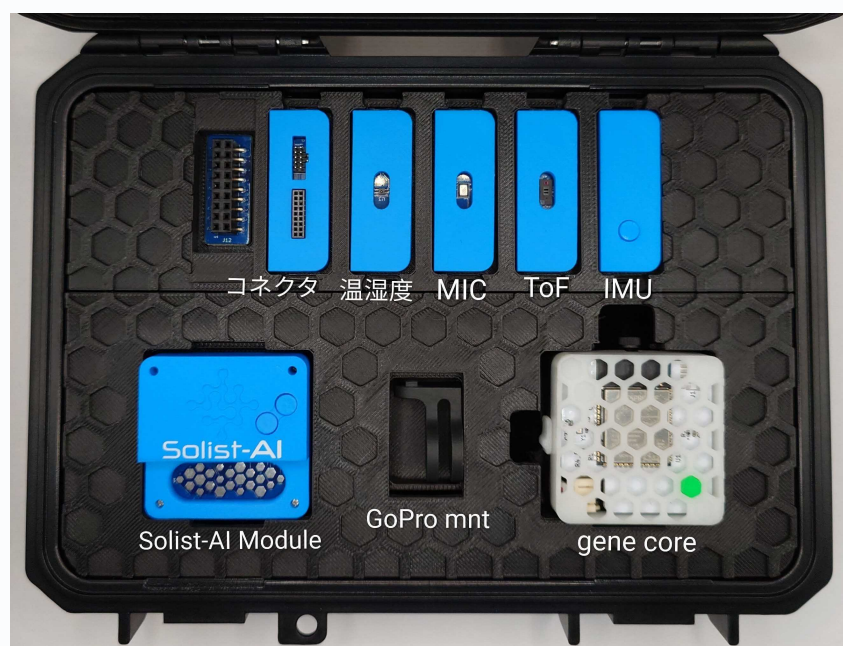
図 1-1 キット内容物。専用ハニカムケースに、ホストの gene core（右下）、モジュールの Honeycomb コネクタに着脱する 5 枚のモジュールボード（上段：左から Conn（コネクタ）／Temp（温度）／MIC／ToF／IMU）、および Solist-AI module（左下）を収納。中央下は GoPro マウント。
