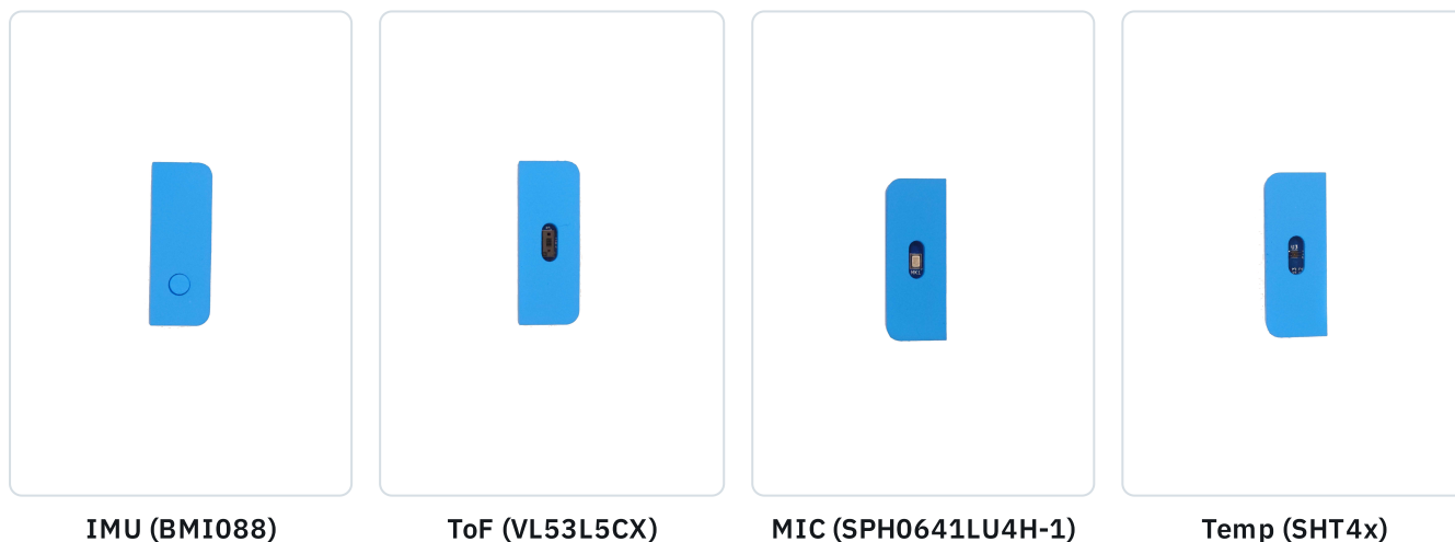
図 5-1 同梱される 4 種のセンサー子基板。いずれも共通の Honeycomb ポゴピン面でモジュールに着脱する。青い部分は 3D プリント製の保護カバーで、窓からセンサ素子が見える。
